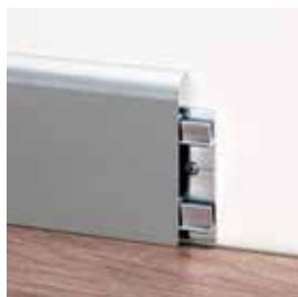
Metal Line 92 e 93 realizzati in alluminio, dal design semplice e lineare rendono impeccabile la giunzione parete pavimento. Facili e veloci da installare con un sistema ad incastro su supporti in alluminio naturale o PVC fissati a parete mediante l'utilizzo di viti e tasselli.
